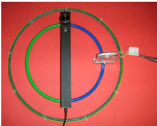
Links und oben: Koppelschleife für Empfängerabgleich
